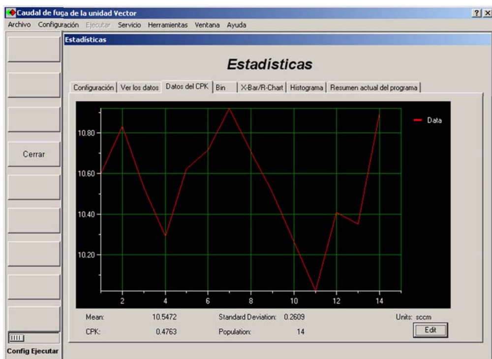
FIGURA 4-23: EL TABULADOR DATOS DEL CPK MUESTRA DATOS DE REPRODUCIBILIDAD Y FACTOR DE TOLERANCIA DE PRECISIÓN
