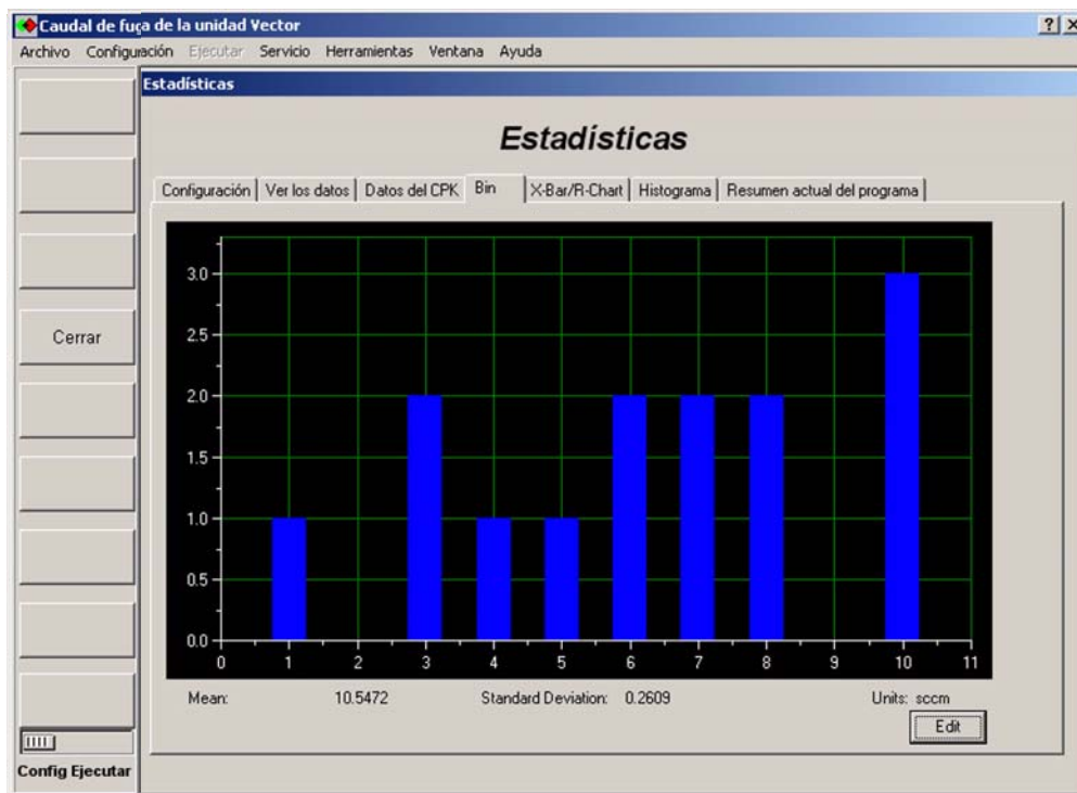
FIGURA 4-25: EL TABULADOR BIN MUESTRA "BINS" DE DATOS PUNTUALES EN LOS CUALES SE CLASIFICAN LOS DATOS ESTADÍSTICOS
